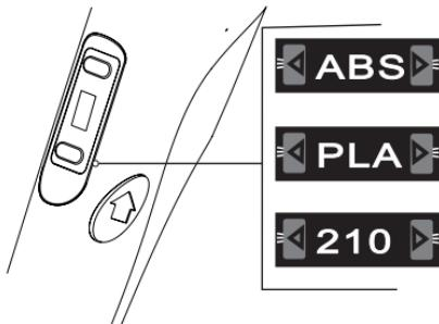
Выберите используемый материал кнопкой регулировки температуры.
