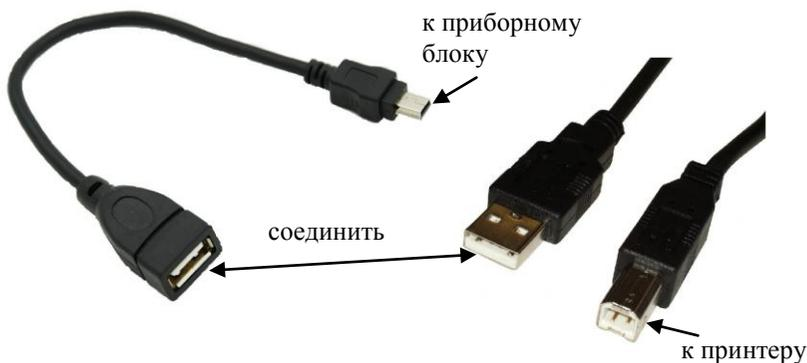
Рисунок 3 – Соединение кабелей
