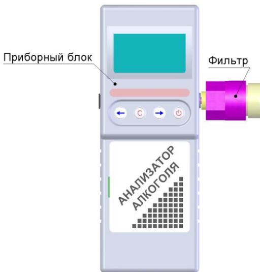
Рисунок 6 – Установка фильтра
