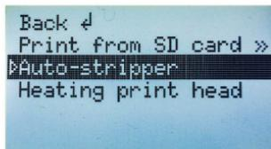
ПРИНТЕР НАЧНЕТ НАГРЕВ ПЕЧАТАЮЩЕГО УСТРОЙСТВА. ДОЖДИТЕСЬ ОКОНЧАНИЯ ПРОЦЕССА.
