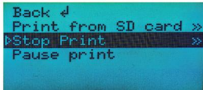
После остановки печати необходимо поднять печатающее устройство, чтобы очистить рабочую поверхность. Для этого медленно и плавно проверните направляющую вручную.
