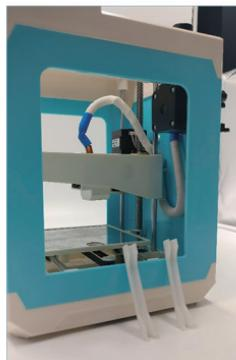
ВКРУТИТЕ ТРАНСПОРТИРОВОЧНУЮ ТРУБКУ ДЛЯ ПОДАЧИ ПЛАСТИКА КАК ПОКАЗАНО НА РИСУНКЕ.
