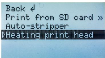
ПРИНТЕР ПРОИЗВЕДЁТ, НАГРЕВ ЭКСТРУДЕРА ДО ТЕМПЕРАТУРЫ 230 °C.
