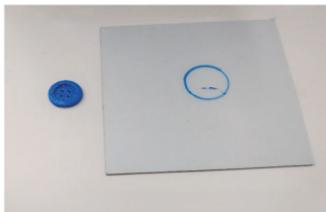
Если данный слой не приклеился к столу, то печатающее сопло расположено выше рабочего положения. Если сопло уперлось в стол и пластик не выходит, значит сопло расположено ниже. Необходимо отрегулировать высоту сопла при помощи калибровочного механизма.
