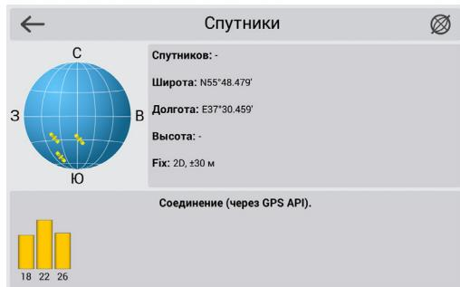
В левой верхней части окна расположено схематическое изображение сферы небосвода с указанием сторон света. Центр полусфера соответствует зениту, ее окружность обозначает линию горизонта. При активированной функции связи со спутниками на полусфере отображаются спутники условными знаками желтого и зеленого цвета. Зеленый цвет обозначает более высокое качество приема сигнала, желтый – более низкое.
