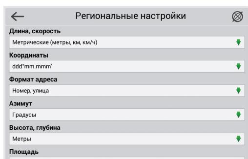
**Единицы измерения** – выбор единиц измерения, которые будут использоваться в программе. Единицы измерения включают в себя: длину, скорость, формат координат, адрес и азимут, а также высоту, глубину и площадь. Для изменения формата единицы измерения, нажмите на раскрывающийся список и выберите подходящий формат.
