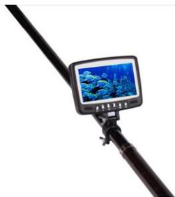
На удилце. Сначала установите металлические кольца на удилце как показано на фотографии 1, затем установите держатель с монитором на металлическую платину, как показано на фотографии 2. Настройте положение монитора для лучшего обзора.
