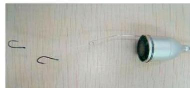
**Предупреждение: не прикрепляйте леску к крючком к кабелю камеры, это может вызвать его разрыв. Используйте для крепления кольцо на объективе.**
