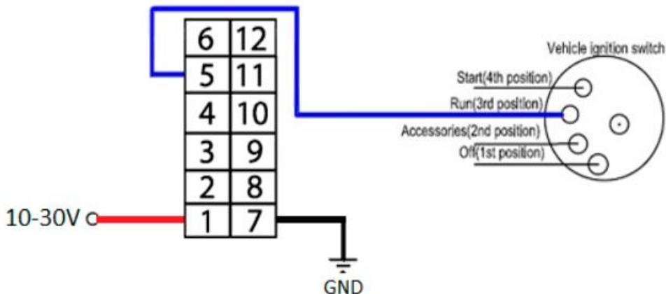
Кроме того, можно контролировать сигнал «Зажигание», найдя любой источник положительного сигнала, который работает только при включенном зажигании, например, источник питания автомагнитолы.
