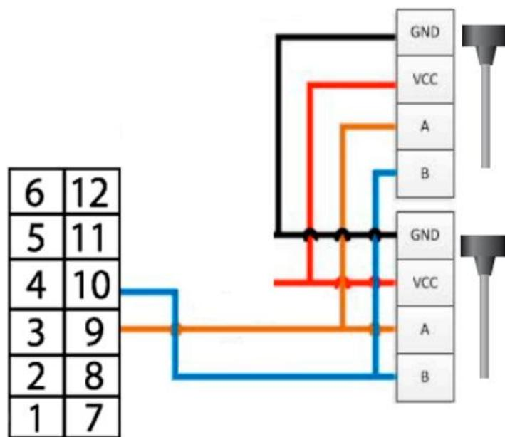
При подключении нескольких датчиков к одному устройству, каждый датчик должен иметь уникальный сетевой адрес.
