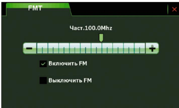
FM-транسمиттер посылает аудиосигнал на автомагнитоу или другое радиоустройство с FM-диапазоном. Например, если выставить на Навигаторе частоту 100 МГц и принимающее устройство настроить на эту же частоту, то все звуковые сигналы Навигатора будут транслироваться через усилитель радиоустройства. Встроенный динамик Навигатора при этом отключается.
