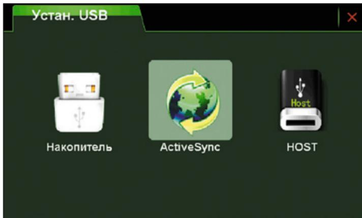
выберите соединение Навигатора с ПК с помощью программы ActiveSync или соединение с ПК в качестве внешнего накопителя или режим HOST. Режим HOST позволяет подключить к Навигатору внешние устройства, в частности, 3G-модем.
